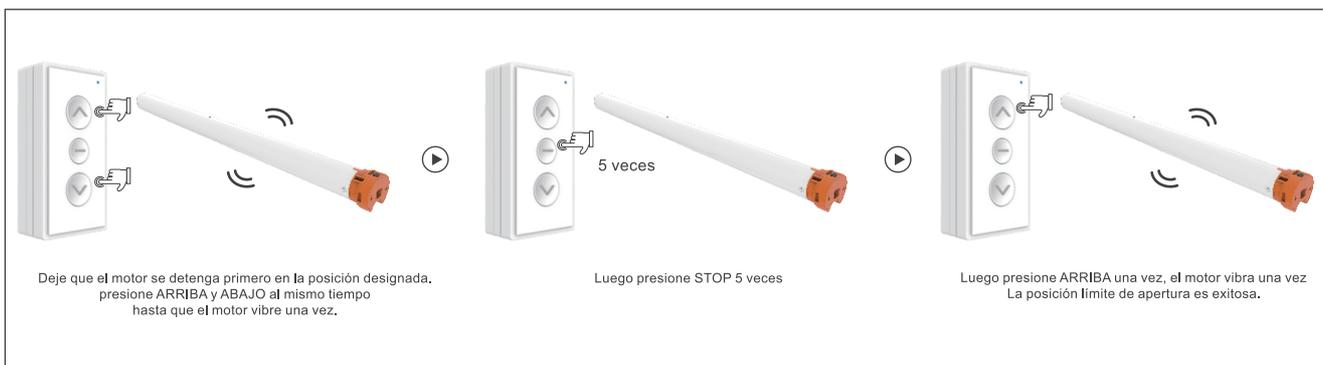
Deje que el motor se detenga primero en la posición designada. Presione ARRIBA y ABAJO al mismo tiempo hasta que el motor vibre una vez.
